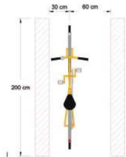
Figure 6 : Cas d'un emplacement isolé
